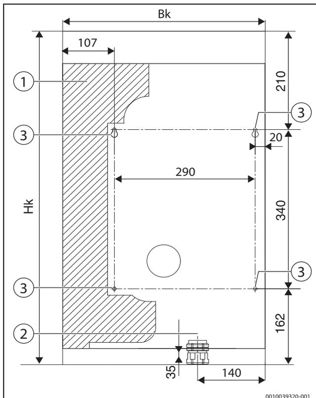
Bild 9 Abmessungen der Bohrungen für das Befestigen des Heizgerätes an der Wand und für das Versorgungskabel beim Heizgerät Logamax E156 15-24 kW
