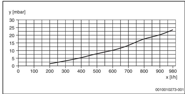
Bild 38 Hydraulischer Widerstand Logamax E156 15...24 kW
