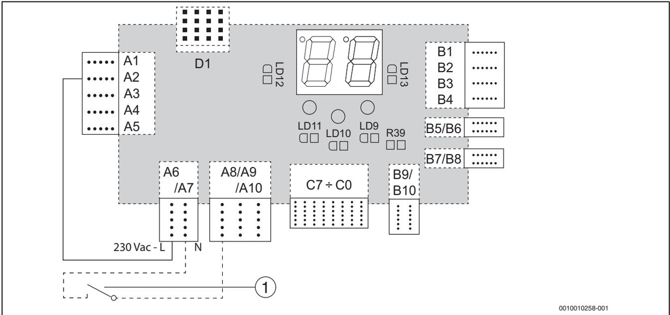
Bild 24 Steuerung des Heizgerätes durch Fernsteuerung (Neutralleiter)
