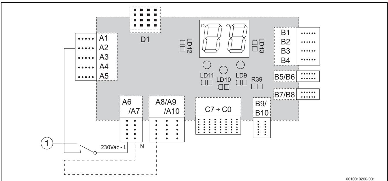
Bild 25 Steuerung des Heizgerätes durch Fernsteuerung (Phasen-Leiter)
