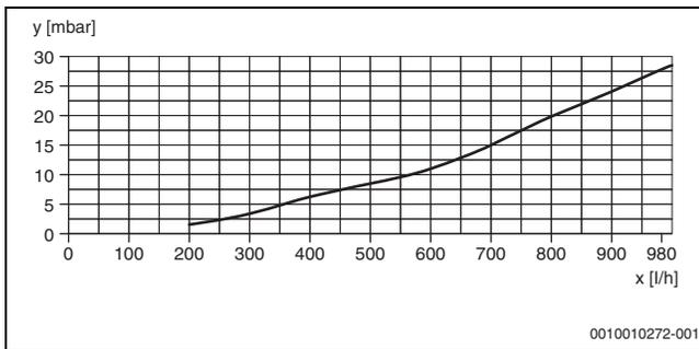
Bild 37 Hydraulischer Widerstand Logamax E156 4...12 kW
