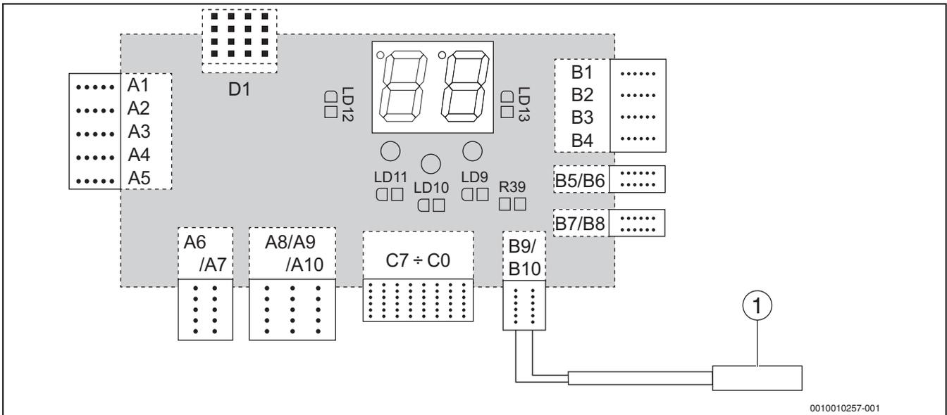
Bild 32 Anschluss eines externen Temperatüföhrers für die minimale Raumtemperatur oder eines zusätzlichen Raumthermostats
