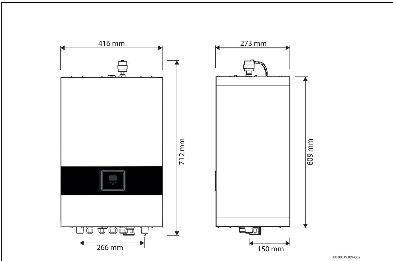
Bild 5 Abmessungen des Heizgerätes 15-24 kW
