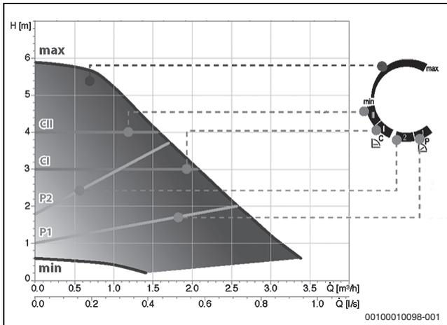
Bild 36 Förderhöhe Heizwasserpumpe für Heizgerät Logamax E156 4...24 kW
