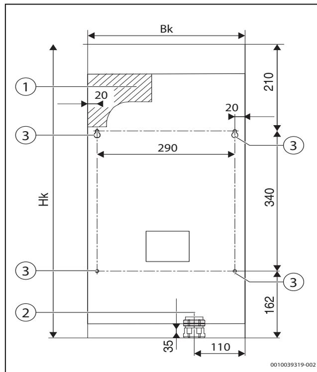
Bild 8 Abmessungen der Bohrungen für das Befestigen des Heizgerätes an der Wand und für das Versorgungskabel beim Heizgerät Logamax E156 4-12 kW
