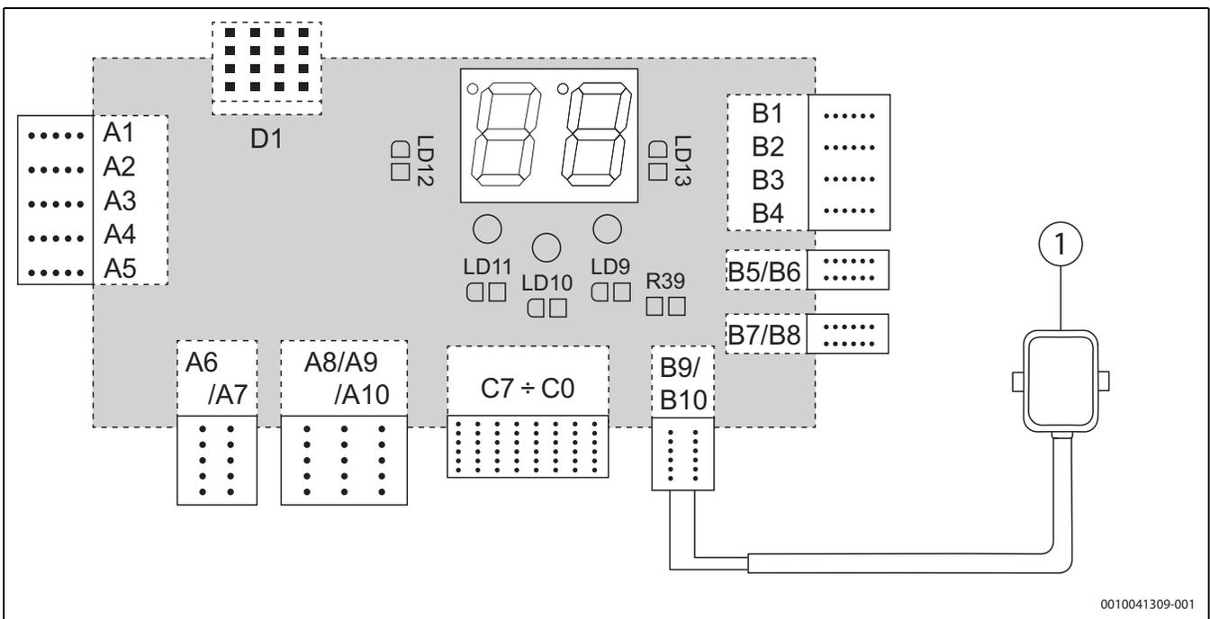
Bild 33 Anschluss eines Außentemperatüföhrers für die außentemperaturgeführte Regelung
