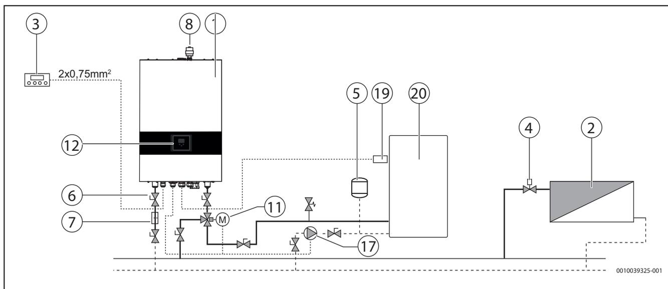
Bild 41 Beispiel für den Anschluss des elektrischen Heizgerätes Logamax E156 als zusätzlicher Wärmeerzeuger
