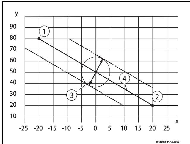
Bild 35 Außentemperaturgeführte Heizkurve
