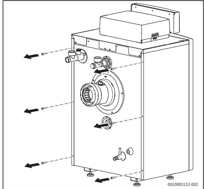
Bild 77 Befestigungsschrauben lösen
