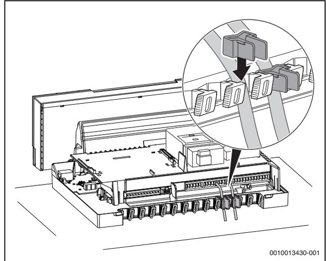
Bild 28 Klemmleiste am Regelgerät
