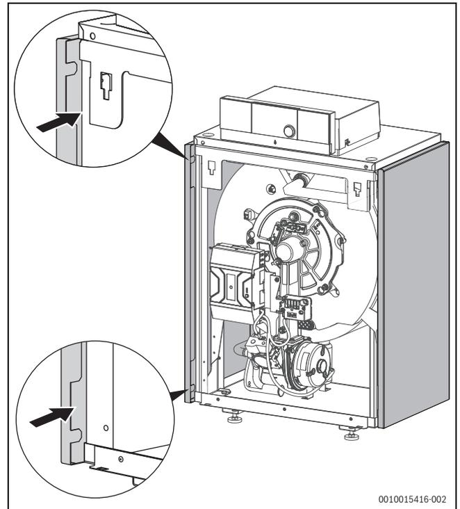
Bild 81 Seitenwände ansetzen und nach hinten schieben
