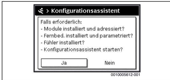
Bild 38 Konfigurationsassistent starten
