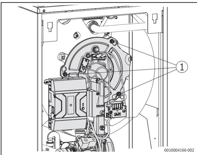
Bild 69 Befestigungsmuttern lösen
