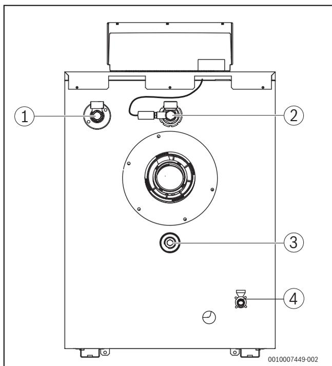
Bild 14 Vorlauf (VK) und Rücklauf (RK) montieren
