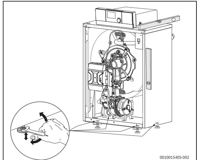
Bild 8 Heizkessel ausrichten
