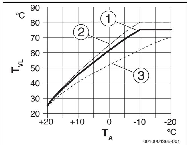
Bild 59 Einstellung der Heizkurve für Heizkörper
