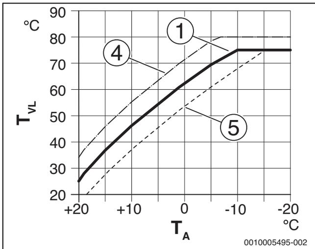
Bild 60 Einstellung der Heizkurve für Heizkörper
