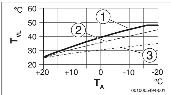
Bild 57 Einstellung der Heizkurve für Fußbodenheizung
