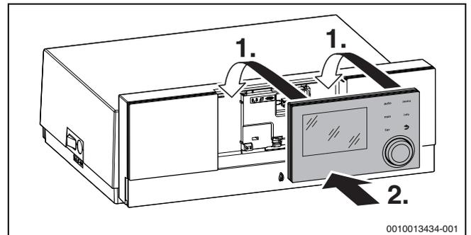
Bild 34 Bedieneinheit einhängen
