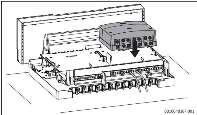
Bild 27 Funktionsmodule einstecken
