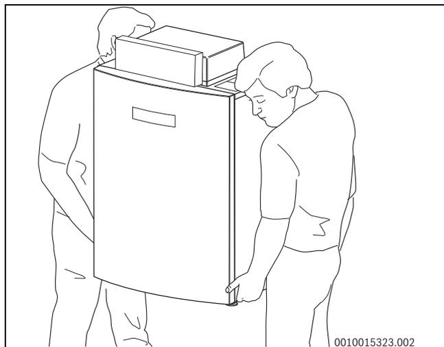
Bild 5 Heizkessel tragen
