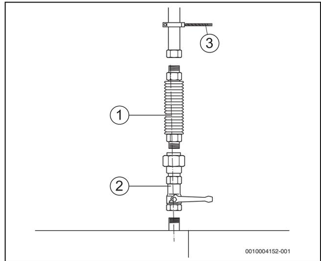
Bild 16 Gasanschluss herstellen
