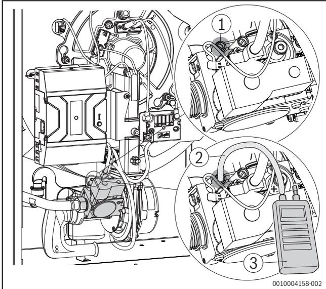
Bild 48 Gas-Anschlussdruck messen
