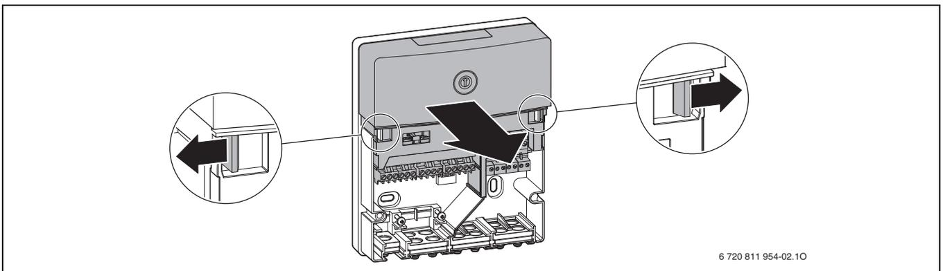
Bild 25 Funktionsmodul entfernen
