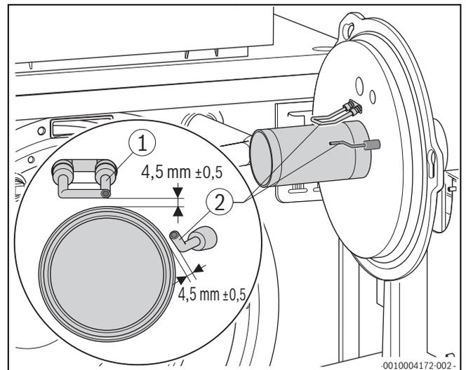
Bild 75 Abstände Elektroden
