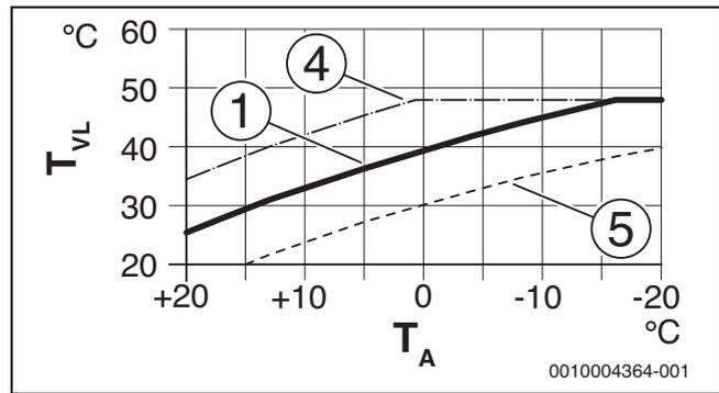
Bild 58 Einstellung der Heizkurve für Fußbodenheizung
