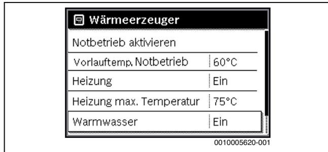
Bild 43 Warmwasserbereitung einschalten
