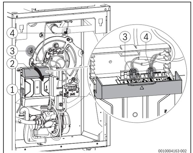
Bild 66 Steckverbinder lösen
