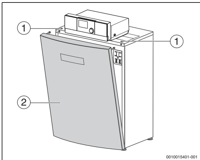
Bild 7 Kesselvorderwand demontieren
