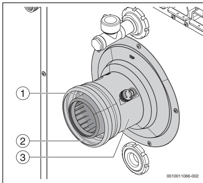
Bild 9 Abgasanschluss montieren
