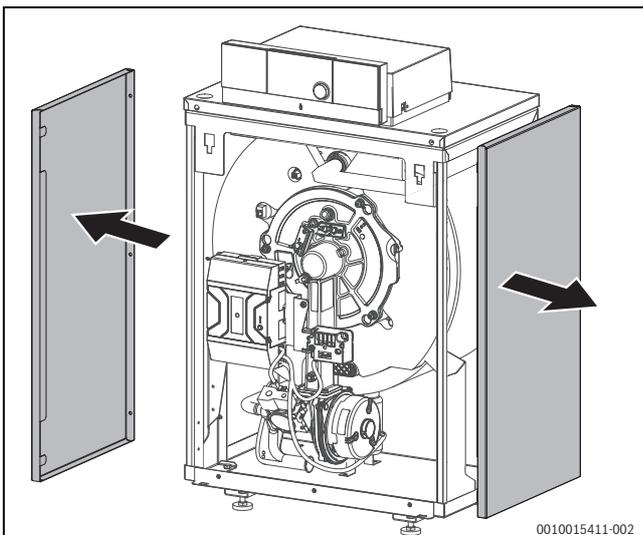
Bild 80 Seitenwände abnehmen
