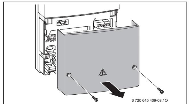
Bild 24 Gehäuse öffnen
