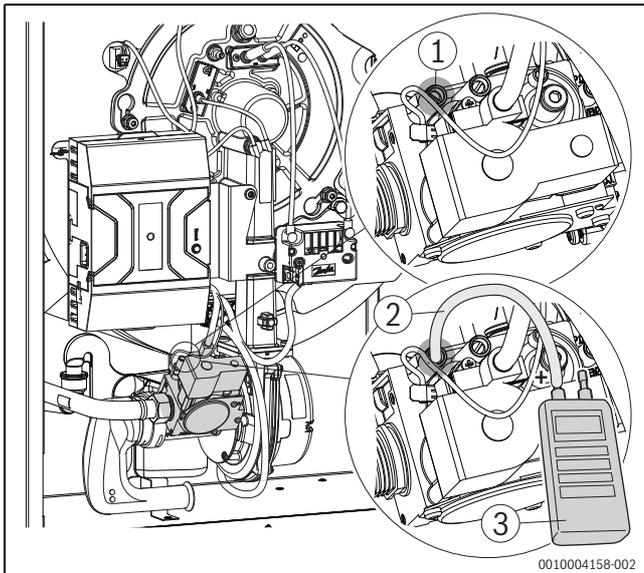
Bild 63 Gas-Anschlussdruck messen
