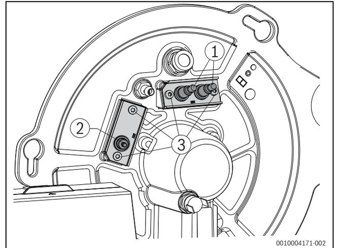
Bild 74 Elektrodenposition
