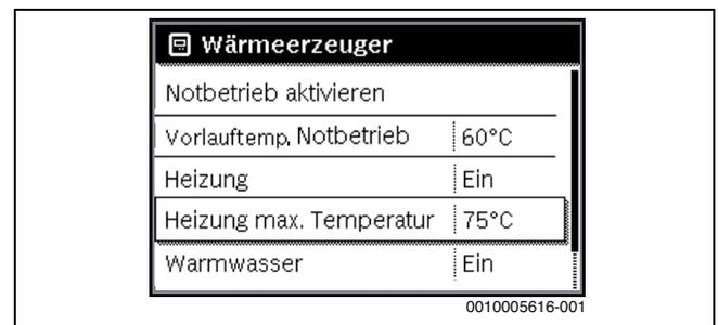
Bild 41 Maximale Vorlauftemperatur
