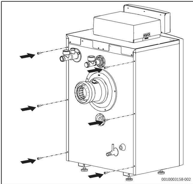
Bild 83 Seitenwände befestigen
