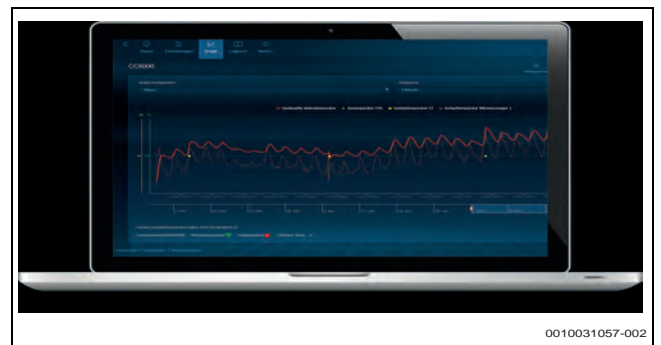
Bild 101 Control Center CommercialPLUS: Graph; Anzeige der aufgezeichneten Datenpunkte. Aktualisierung alle 6 Stunden automatisch oder manuell sofort. Max. Speicherdauer: 2 Jahre, Auflösung: 0,5°-Schritte; bis zu max. 125 Datenpunkte
