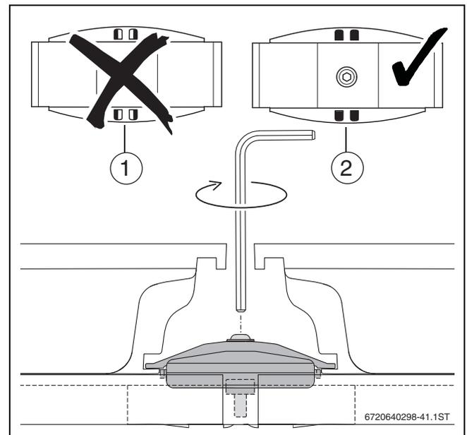
Bild 49 Kollektorspanner montiert
