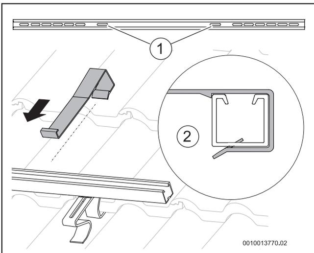
Bild 41 Abrutschsicherung montieren
