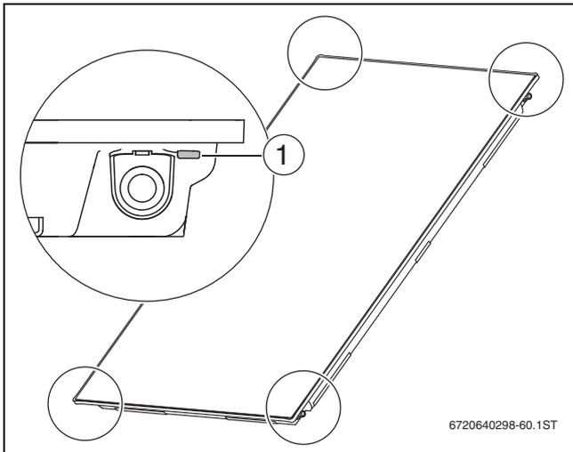
Bild 65 Belüftungsöffnungen
