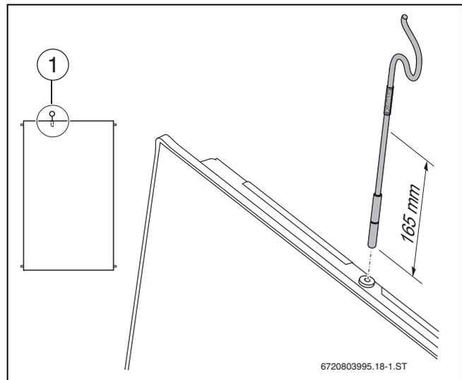
Bild 53 Kolleortemperaturfühler montieren
