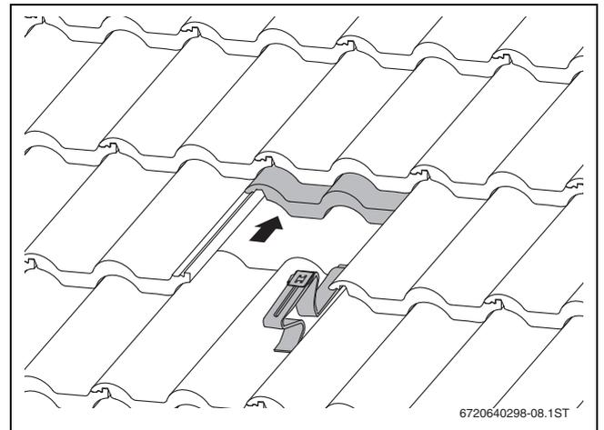
Bild 21 Eingehängter Dachhaken
