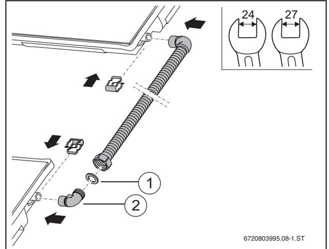
Bild 62 Anschlussrohr montieren
