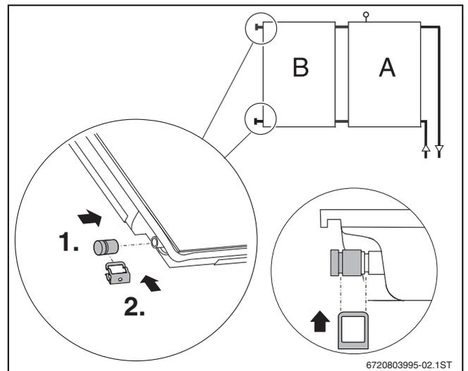
Bild 42 Kappen montieren
