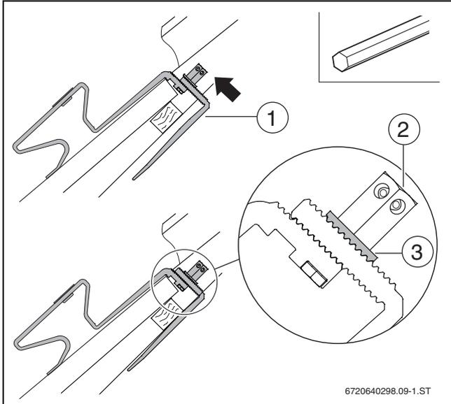
Bild 22 Dachhaken-Unterteil hochschieben
