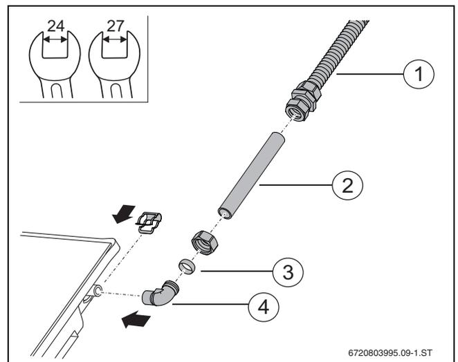
Bild 63 Verbindungs-Set montieren
