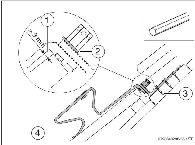
Bild 26 Sparrenanker befestigen
