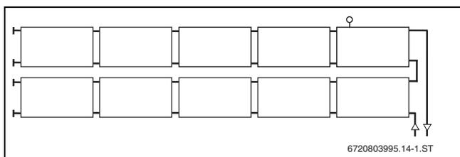
Bild 11 Gleichseitiger Anschluss waagerechter Kollektoren (2 Reihen)
