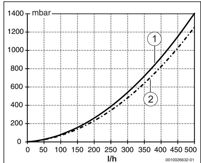
Bild 3 Druckverlustkurve (Wasser-Glykol-Gemisch)
