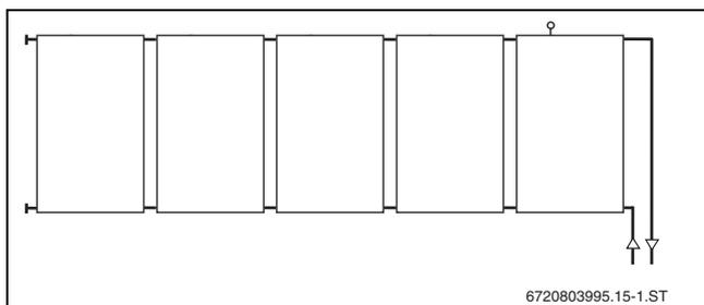
Bild 10 Gleichseitiger Anschluss rechts oder links (1 Reihe)
