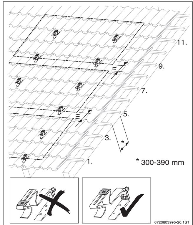
Bild 18 Abstände der Dachhaken bei 3 waagerechten Kollektoren
