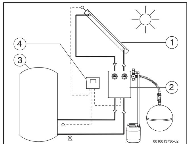
Bild 4 Beispielhafte Darstellung einer Solaranlage
