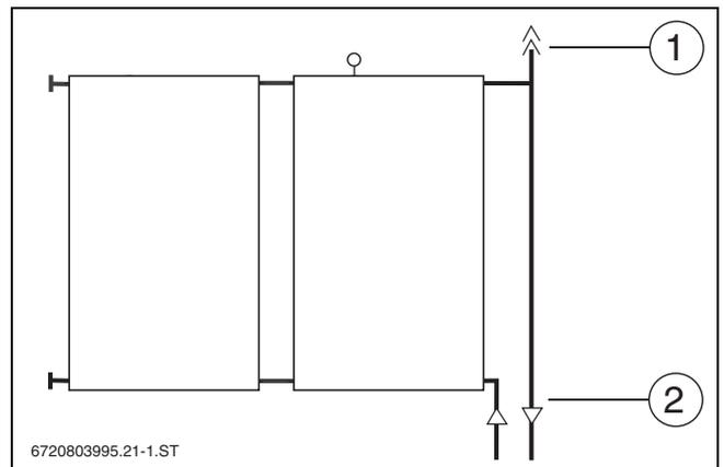
Bild 56 Hydraulischer Anschluss mit Entlüfter (Vorlauf rechts)
