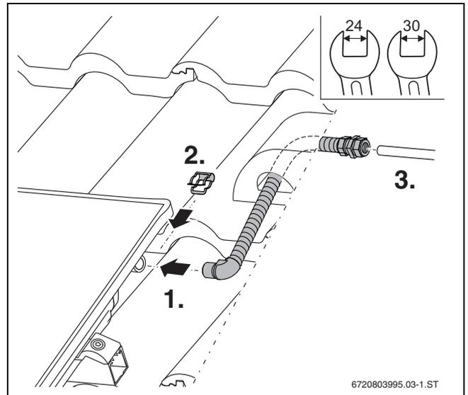
Bild 55 Anschlussrohr (Vorlauf) durch das Dach führen
