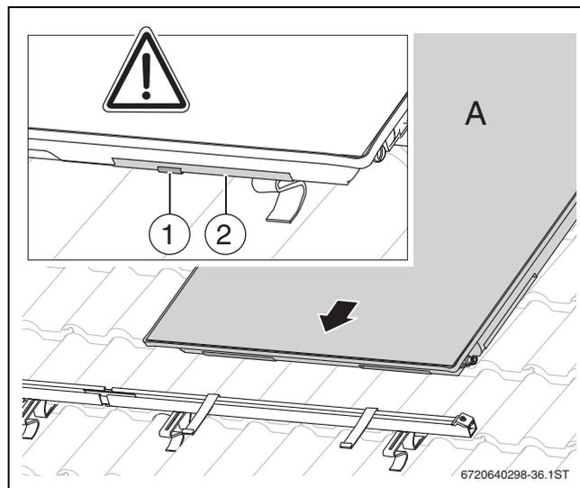
Bild 45 Kollektor in die Abrutschsicherungen gleiten lassen
