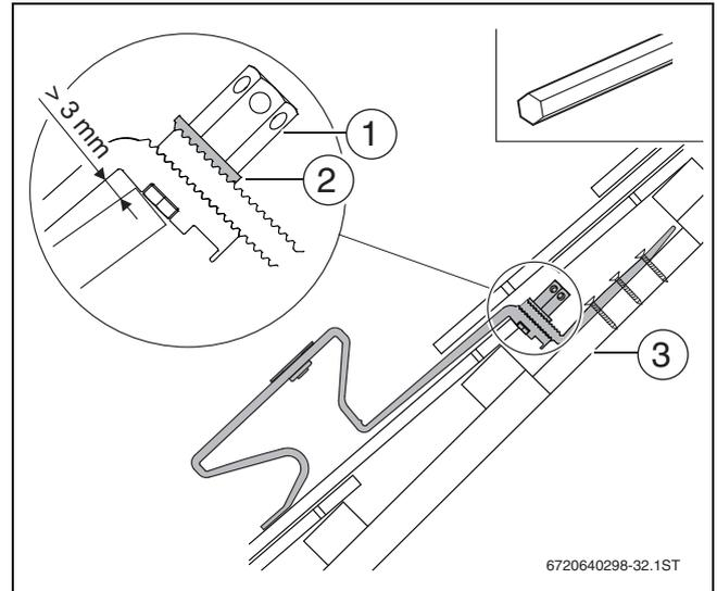
Bild 27 Sparrenanker montieren
