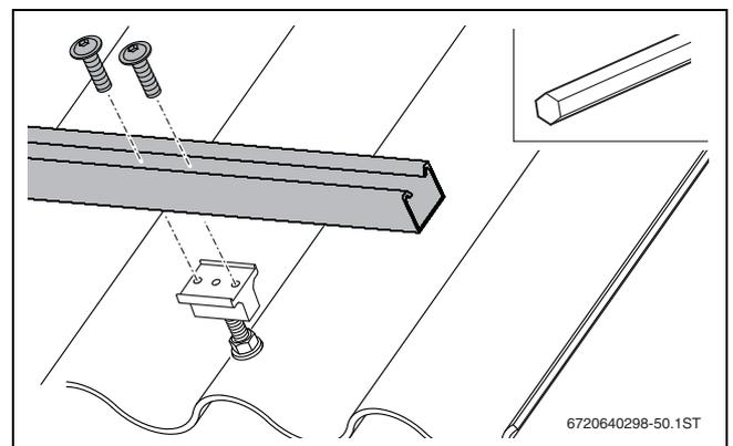
Bild 34 Profilschienen montieren
