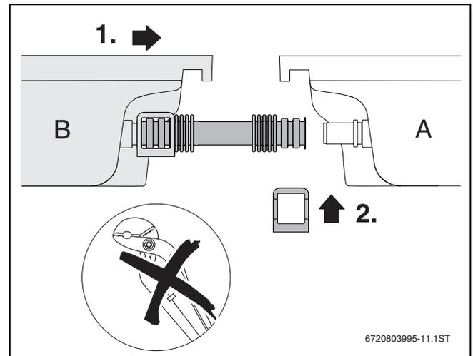
Bild 48 Zweiten Kollektor an den ersten Kollektor schieben
