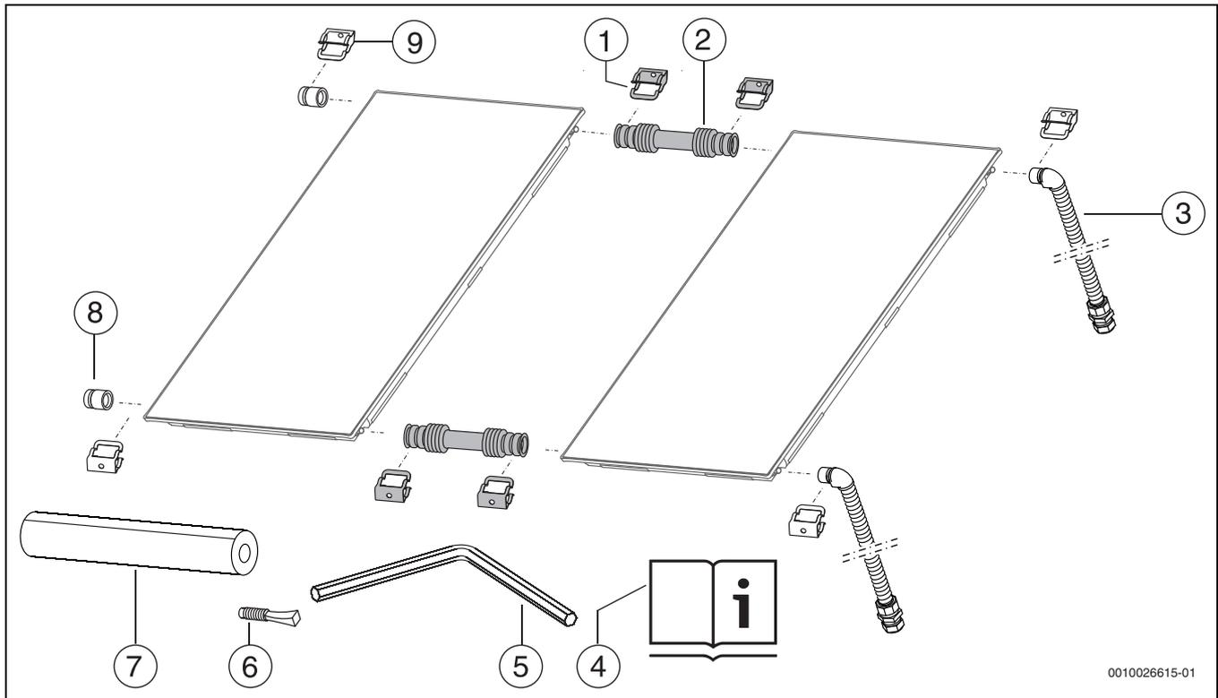
Bild 6 1 Anschluss-Set Aufdach und 2 Verbindungs-Sets (grau)
