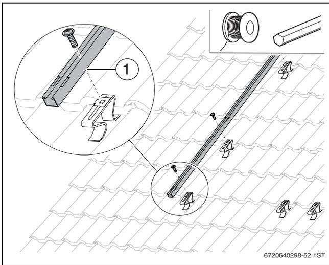
Bild 36 Schneelastprofil montieren
