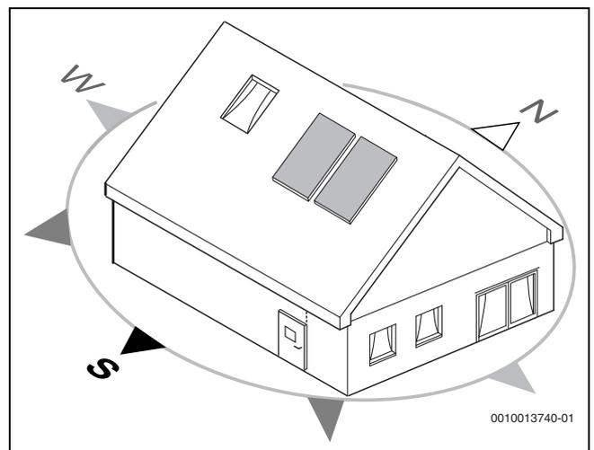
Bild 8 Kollektorfeld ausrichten
