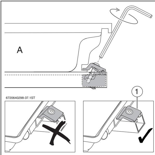
Bild 46 Kollektorspanner festdrehen
