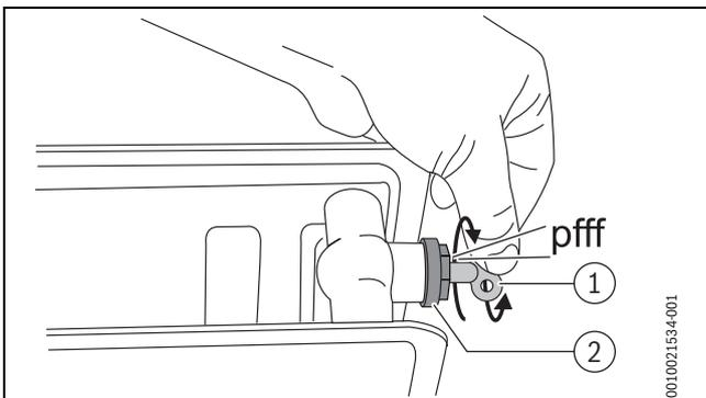
Bild 13 Heizkörper entlüften
