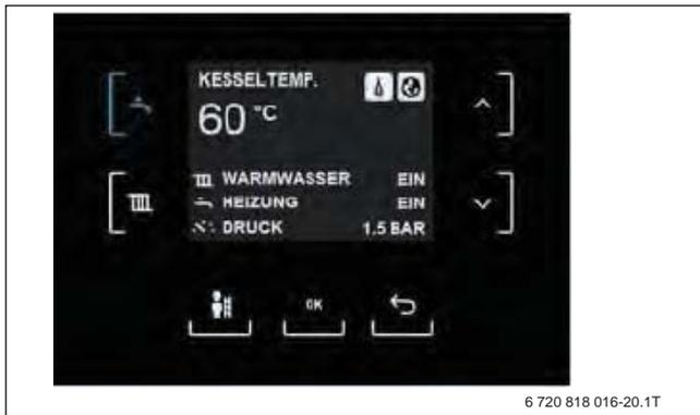
Bild 45 Basiscontroller Logamatic BC30 E
