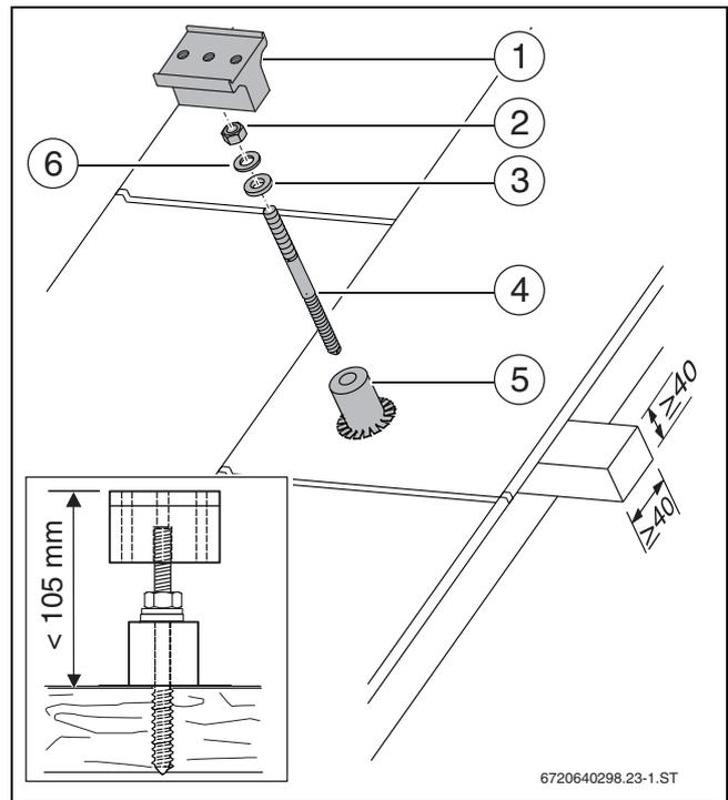
Bild 27 Stockschraube montieren
