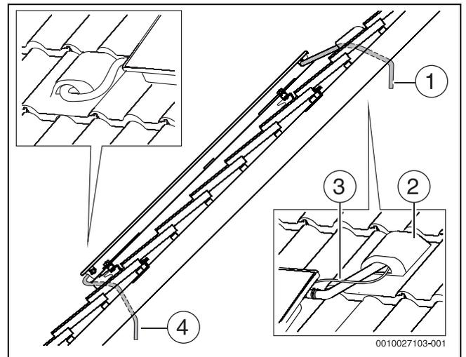
Bild 53 Solarschlauch durch das Dach führen
