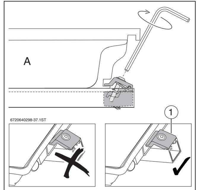
Bild 45 Kollektorspanner festdrehen
