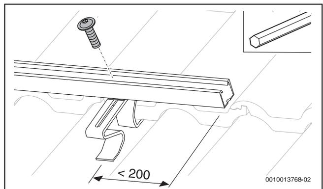
Bild 36 Profilschiene montieren
