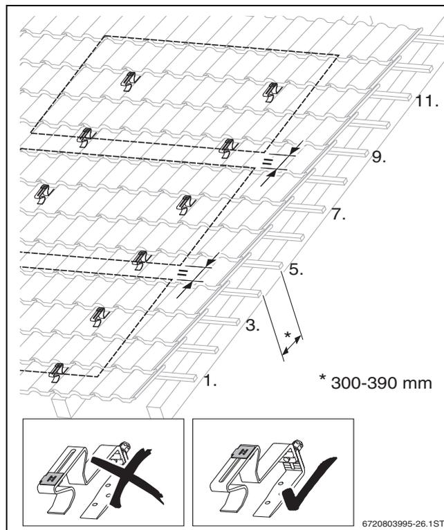
Bild 15 Abstände der Dachhaken bei 3 waagerechten Kollektoren
