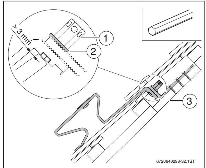
Bild 24 Sparrenanker montieren
