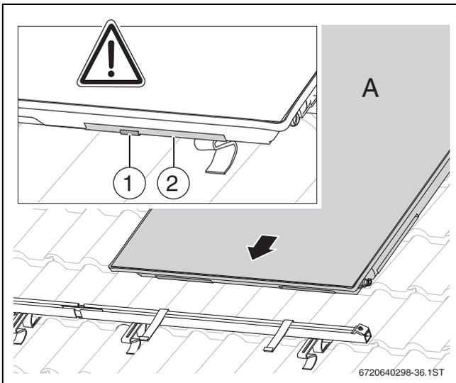
Bild 44 Kollektor in die Abrutschsicherungen gleiten lassen
