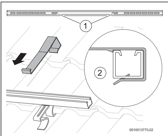
Bild 38 Abrutschsicherung montieren
