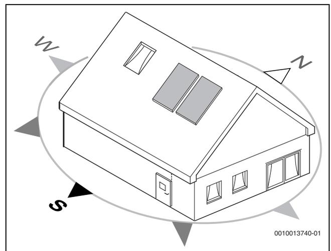
Bild 8 Kollektorfeld ausrichten
