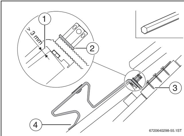
Bild 23 Sparrenanker befestigen
