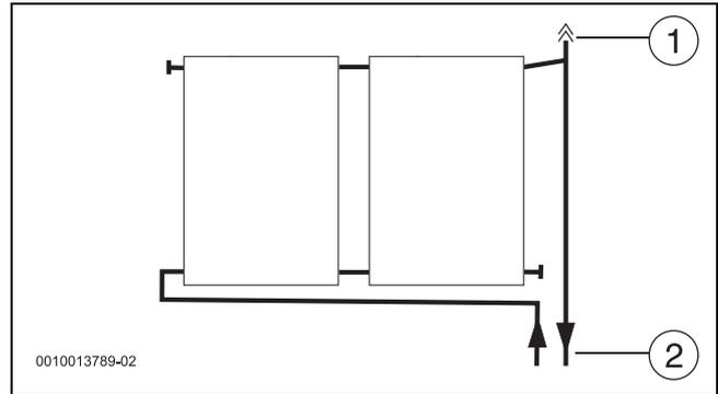
Bild 56 Hydraulischer Anschluss mit Entlüfter (Vorlauf rechts)
