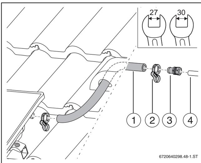
Bild 55 Solar Schlauch (Vorlauf) durch das Dach führen
