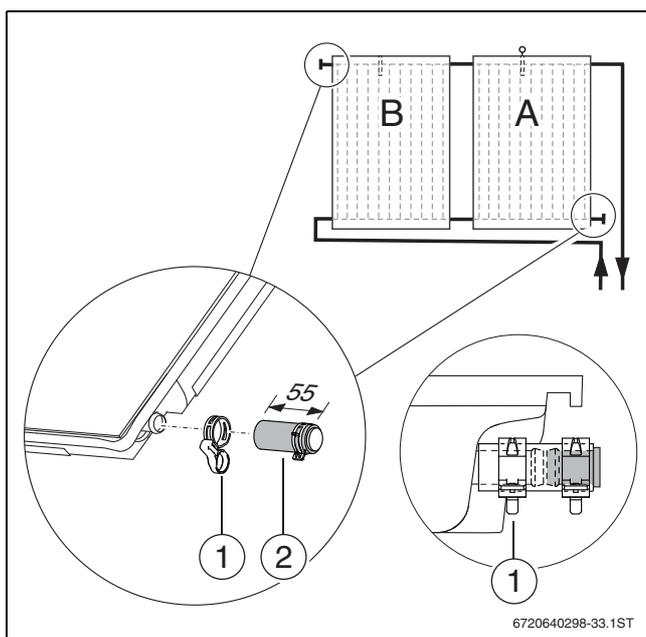
Bild 41 Stopfen montieren
