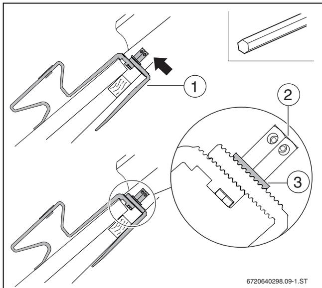
Bild 19 Dachhaken-Unterteil hochschieben
