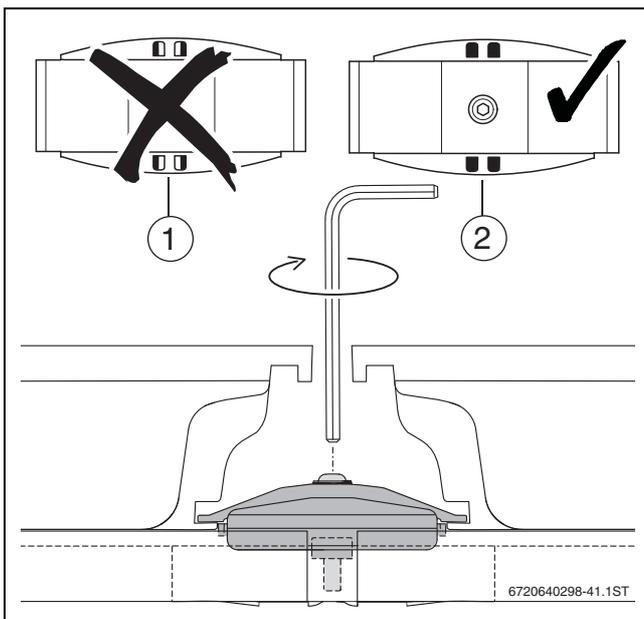
Bild 48 Kollektorspanner montiert
