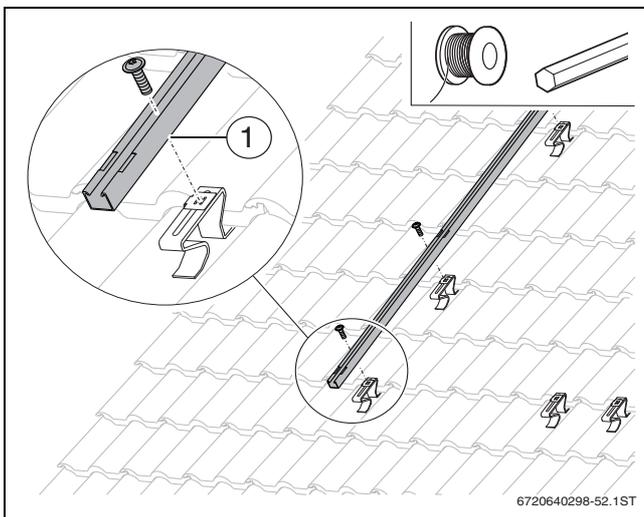
Bild 33 Schneelastprofil montieren
