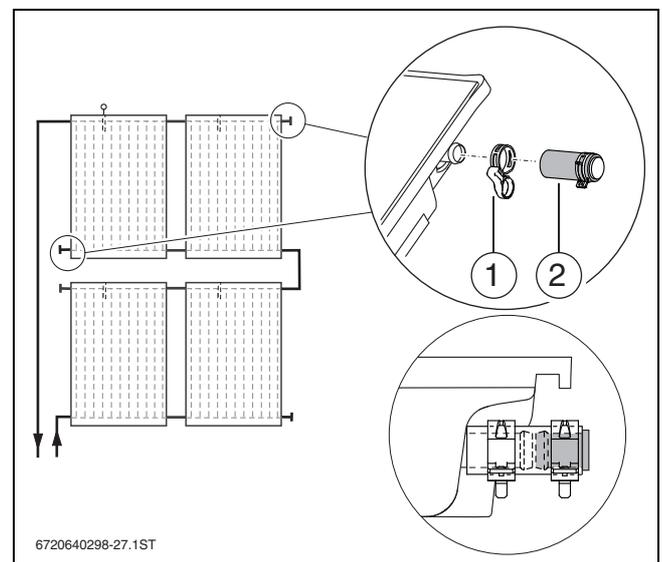
Bild 61 Stopfen montieren
