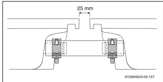
Bild 49 Kollektoren zusammengeschoben
