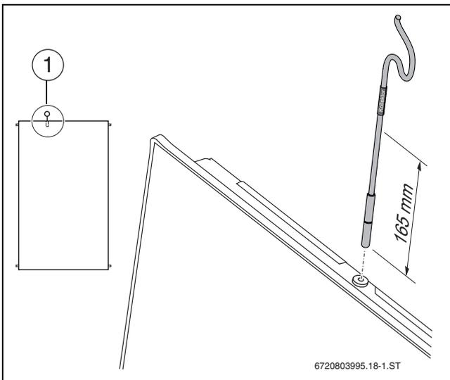
Bild 52 Kolleortemperaturfühler montieren
