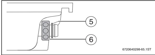
Bild 62 Überwurfmutter montieren
