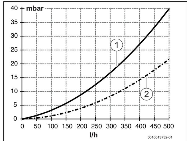
Bild 3 Druckverlustkurve (Wasser-Glykol-Gemisch)
