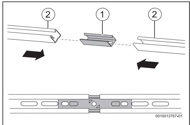
Bild 35 Profilschienen verbinden
