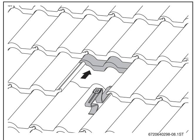
Bild 18 Eingehängter Dachhaken
