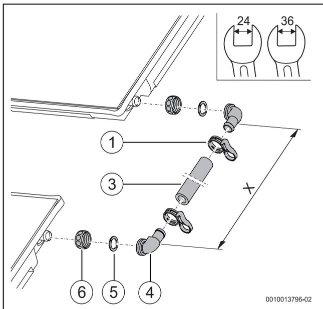
Bild 63 Verbindungs-Set montieren
