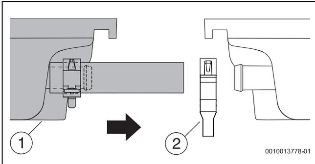
Bild 47 Zweiten Kollektor an den ersten Kollektor schieben
