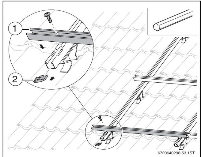
Bild 34 Profilschienen montieren
