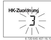
Nach der Zuordnung des Heizkreises ist die Konfiguration als Fernbedienung abgeschlossen. Das Installationsdatum der RC200 wird automatisch gesetzt.
