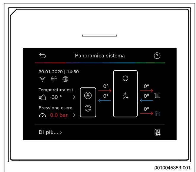
Fig. 11 Panoramica di sistema pompa di calore
